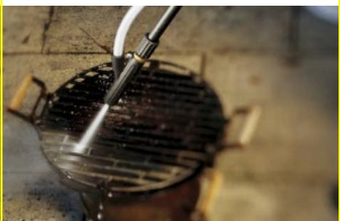
**UTILISATION :** Combiné au dispositif d'hydrosablage, il élimine les traces de rouilles, les tâches de peintures et toutes les salissures tenaces.
