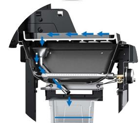
Gouttière d'évacuation des graisses les guidant vers un large bac de récupération permettant de garder la cuve propre.
