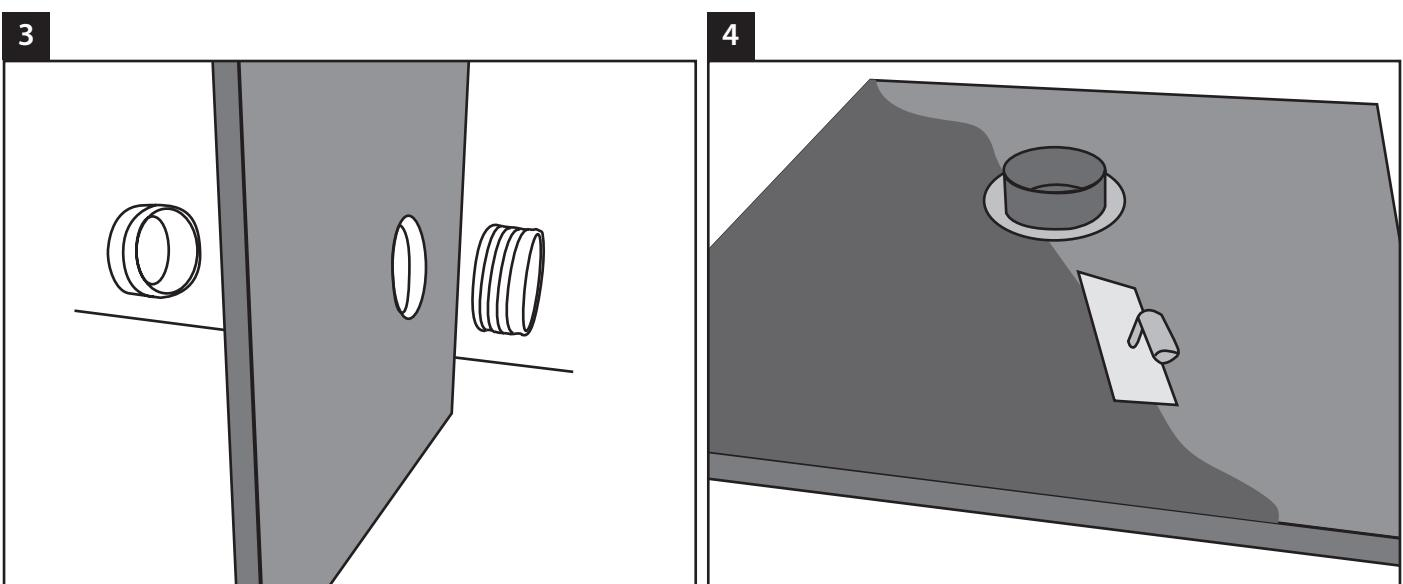
3. Insérez le joint torique par le haut dans la rainure du cadre en matière plastique et vissez la valve à vis pour receveur à carreler avec le joint à lèvres.
