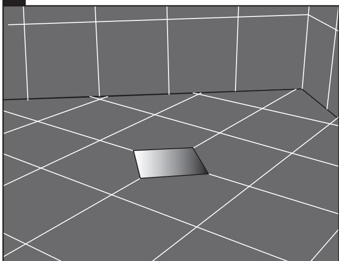
7. Carreler l'élément puis ajuster la bonde avant de la poser
