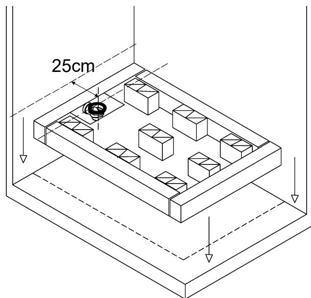
Attention : Les supports doivent imperativement être espaces au MAXIMUM de 200 mm.
