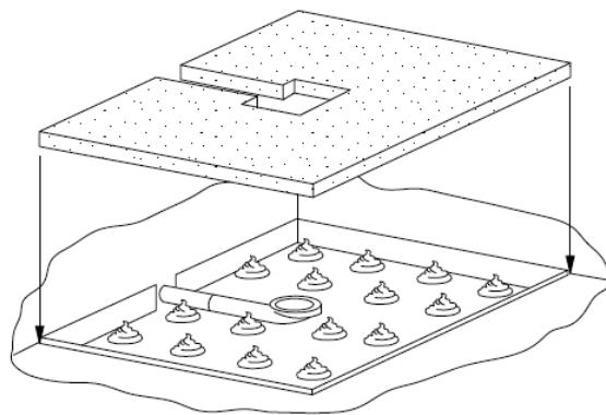
Remplir les rainures du receveur avec le mortier pour éviter son affaissement .
