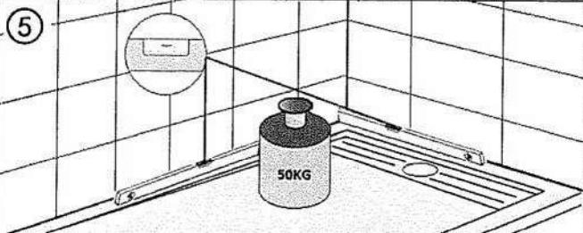
**NB :** Le modèle P33 AYANT UNE ZONE PLATE, il doit être posé avec une légère pente vers la bonde, afin d'évacuer l'eau parfaitement.
