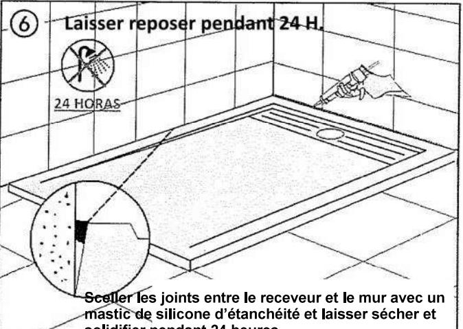
Sceller les joints entre le receveur et le mur avec un mastic de silicone d'étanchéité et laisser sécher et solidifier pendant 24 heures.
