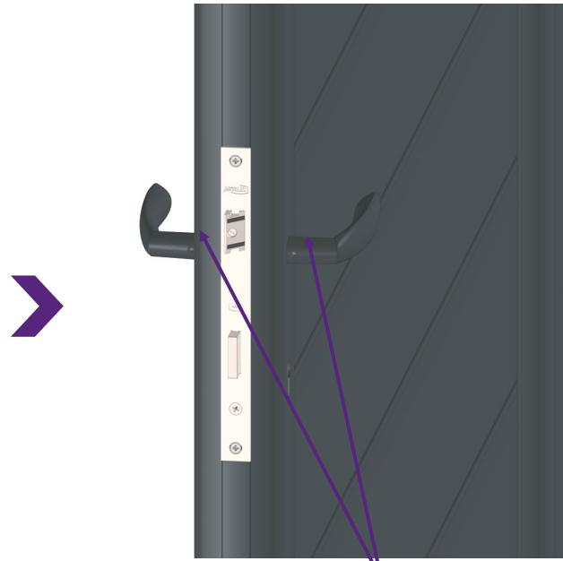
Clipper la béquille (ou serrer les vis suivant le modèle).
