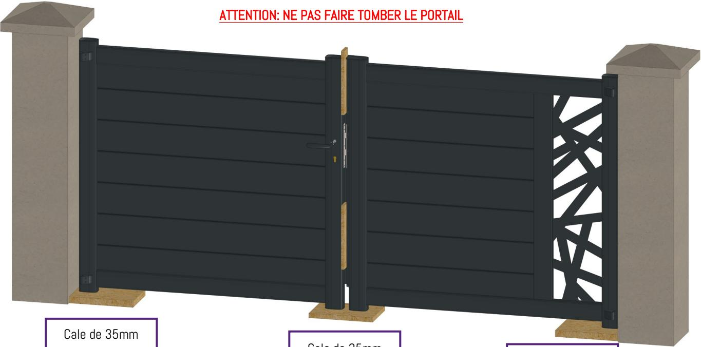
Positionner au centre et sur les cales les 2 vantaux solidarisés entre les piliers
