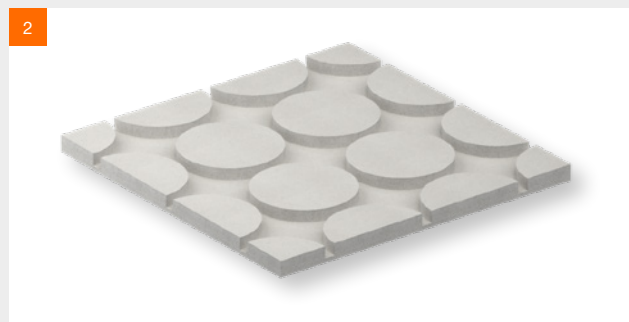
Plaque à plots pour la pose des tubes, à disposer dans les endroits singuliers (distances entre les réservations : 167 mm)
