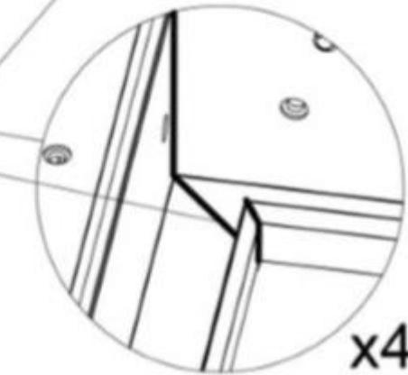
Pour maximiser l'étanchéité des gouttières, appliquer un mastic d'étanchéité d'extérieur (non fourni) à toutes les pièces en contact.
