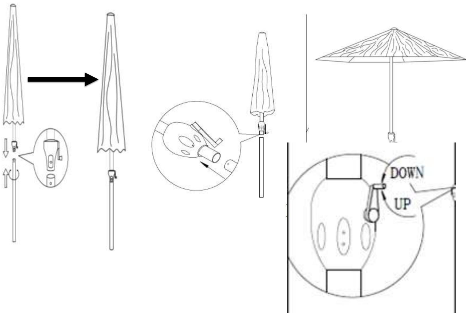
**Attention à ne pas mouliner plus que nécessaire lors de l'ouverture et fermeture afin d'éviter que la corde se détache à l'intérieur du mat!**
