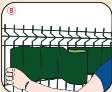
Le montage des lames horizontales glissent facilement dans les mailles du panneau pour une occultation totale. On peut les fixer aux extrémités par serflex.
