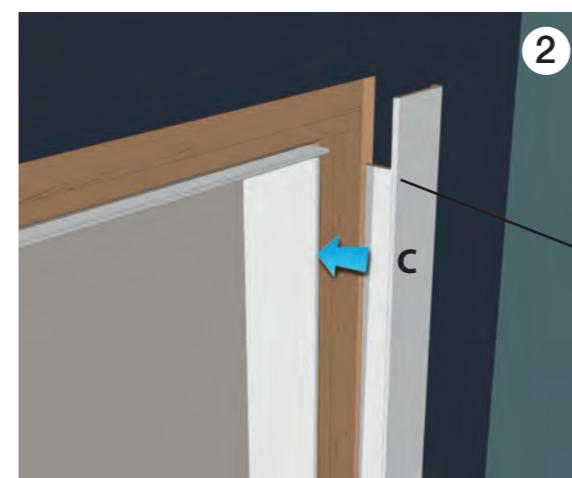
Présenter les profils d'angles verticaux (C). Prendre la mesure sous B. Découper l'angle intérieur haut et emboîter le profil C. Répéter l'opération sur les autres profils.
