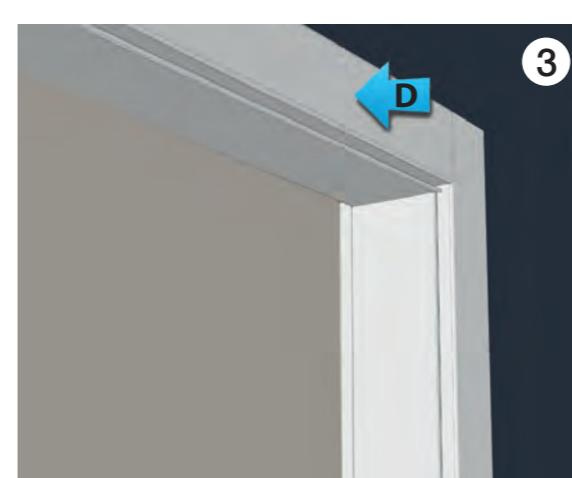
Couper le profil d'angle D en deux parties égales. Ajuster la longueur du profil d'angle D aux profils C. Ajuster la hauteur des profils C à D. Répéter les étapes 2 et 3 sur les trois angles restants.
