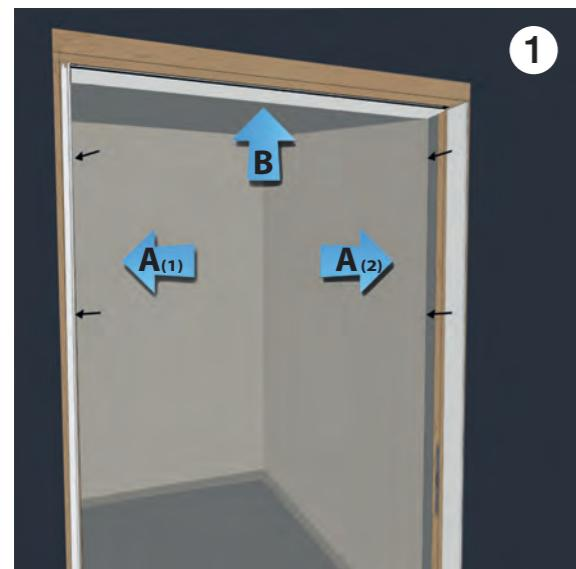
Mesurer les profils A<sub>(1)</sub> et A<sub>(2)</sub> aux dormants verticaux, et le profil B au dormant horizontal (voir schéma ci-contre).
