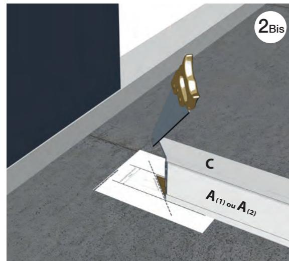
Une fois les 3 profils assemblés, positionner l'ensemble sur le patron de découpe fourni (voir p.5).
