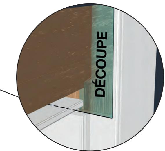
Réaliser la découpe à l'aide d'une scie à dents fines.
