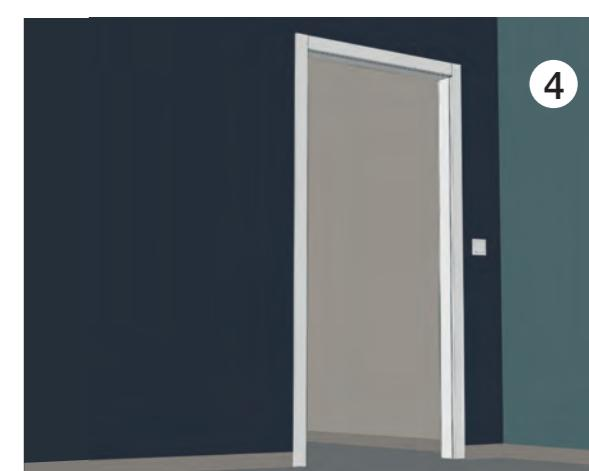
Fixer par collage chaque partie avec de la colle néoprène ou à bois (ne pas mettre en contact avec des matériaux humides tels que plâtre, mortier de collage, etc...).
