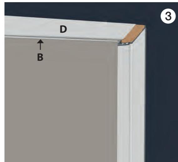
Pour l'assemblage du profil B, couper le profil D en deux parties égales, puis les insérer dans le profil B. Procéder de la même manière que pour les profils A<sub>(1)</sub> et A<sub>(2)</sub> pour la découpe des angles à 45° sur chacune des extrémités du profil B (voir étape 2).
