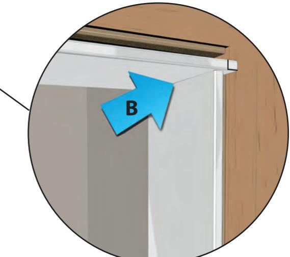
Positionner le profil A<sub>(1)</sub>, puis B et terminer par A<sub>(2)</sub>. Couper les 4 angles du profil B sur 1cm/1cm pour emboîter les 4 profils C.
