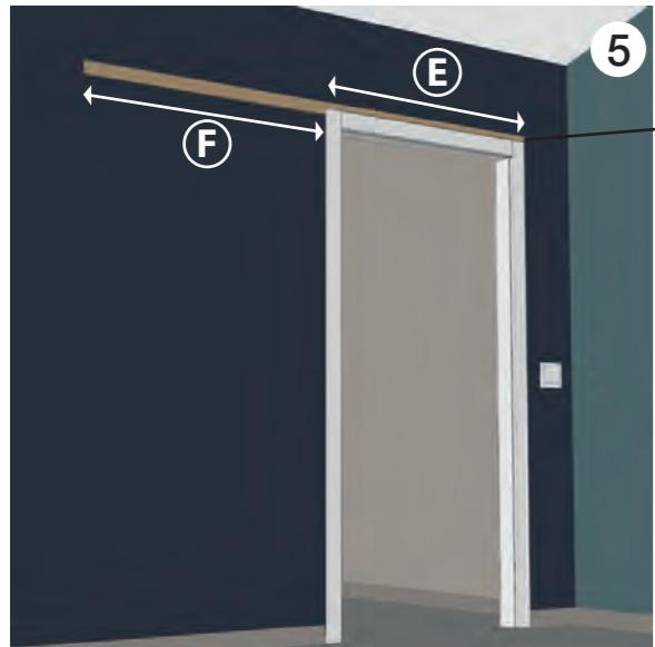
Fixer les deux adaptateurs MDF pour la mise en place du rail de la porte coulissante.
