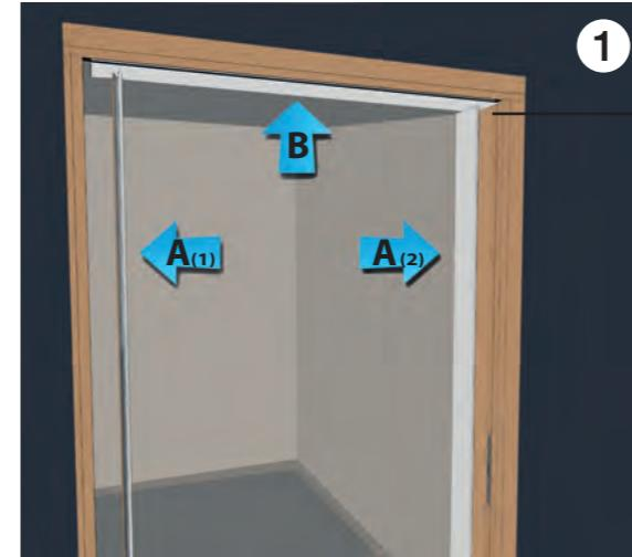
Mesurer le profil B à la bonne largeur, puis les profils A<sub>(1)</sub> et A<sub>(2)</sub> à la bonne hauteur **sous** le profil B. Couper et ajuster l'ensemble.
