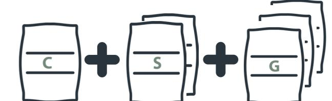
25 kg de ciment + 50 kg de sable à batir + 75 kg de gravier pour béton
