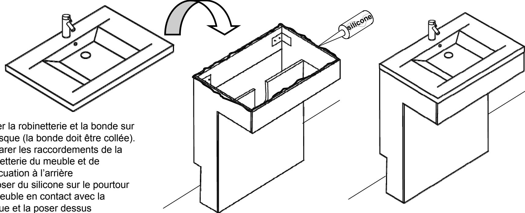
Visser la robinetterie et la bonde sur la vasque (la bonde doit être collée). Préparer les raccordements de la robinetterie du meuble et de l'évacuation à l'arrière. Déposer du silicone sur le pourtour du meuble en contact avec la vasque et la poser dessus
