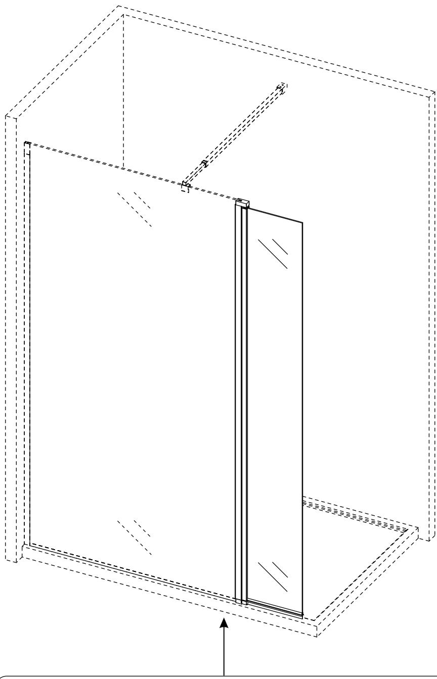
En cas de pose sur un receveur à carreler ou douche italienne : perçage possible
